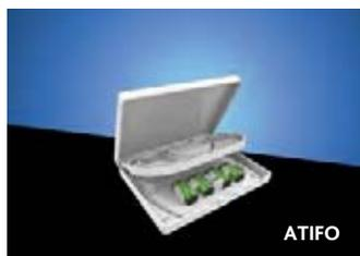
Acessório para distribuição de Fibra Óptica com 4 alinhadores SC/APC que ligam 2 fibras oriundas do repartidor geral de fibra óptica e 2 fibras a ligar na ZAP de nova geração. Todos os kits de ATI categoria 6 incluem o acessório ATIFO para a fibra óptica.
